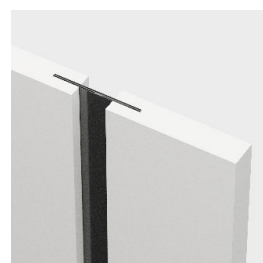
łączenie z szybą „na kant” skrzydło bezprzylgowe
