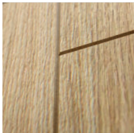
zbliżenie na frezowanie - widoczna struktura dębu naturalnego
